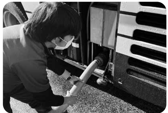
▲トイレの引き抜き作業中。
